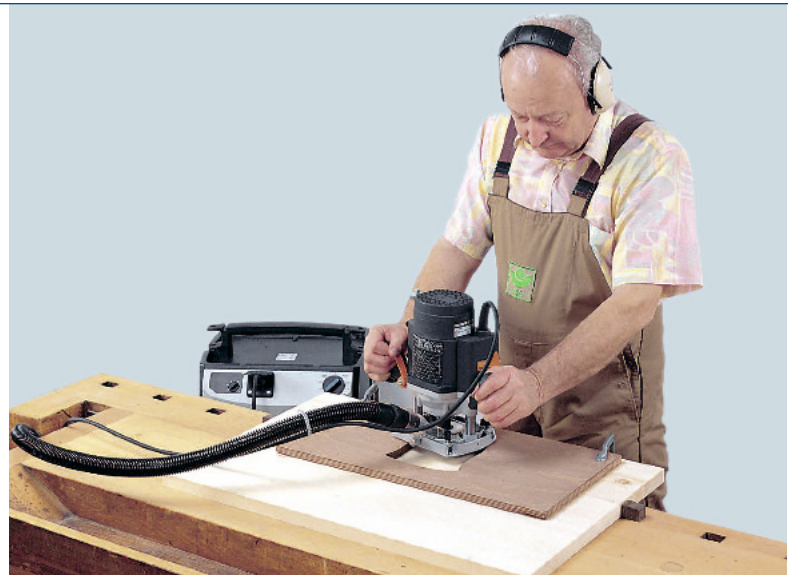
Bei lauten Handmaschinen wird der Grenzwert von neuerdings 85 dB(A) für das Tragen eines Gehörschutzes sehr schnell überschritten (Foto: Holz-BG)
