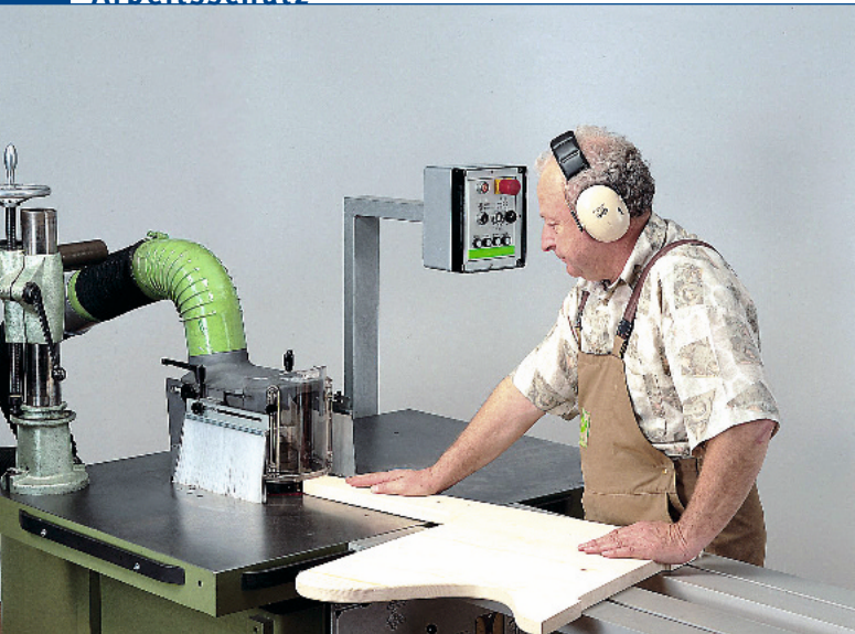
Maschinenräume in Schreinereien werden immer als Lärmbereich eingestuft. Sie liegen erfahrungsgemäß über 85 dB(A) (Foto: Holz-BG)
